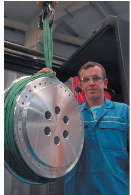
Цельные алюминиевые колеса весом 90 кг и диаметром 900 мм будут вращаться до 177 раз в секунду на максимальной скорости
